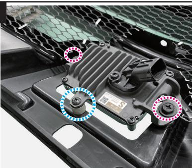
○部 図 4-A を参考に純正ナットのナット部を車両前方に向けて取付け、純正ボルトで仮止めし、○部は図 4-B の様に付属 a、b、c で、付属 b を 3 枚入れて固定し各部を本締めして下さい。
