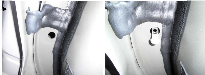
左側フレームの穴に、M8インプルナットを取付けてください。
