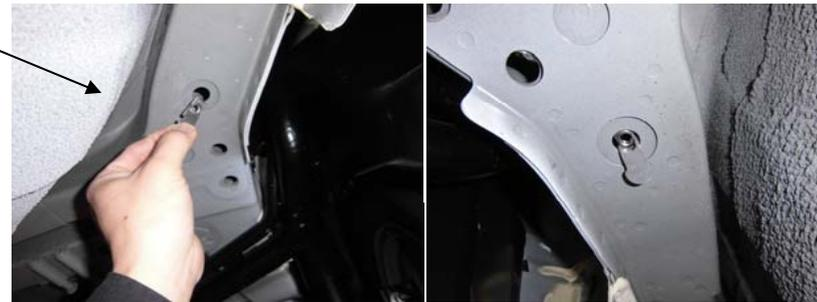
右側フレームの穴に、M8インプルナットを取付けてください。
