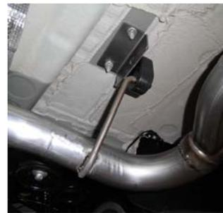
右側純正ブラケットと同じ要領で、純正ナットを使用して左側に取り付けしてください。
