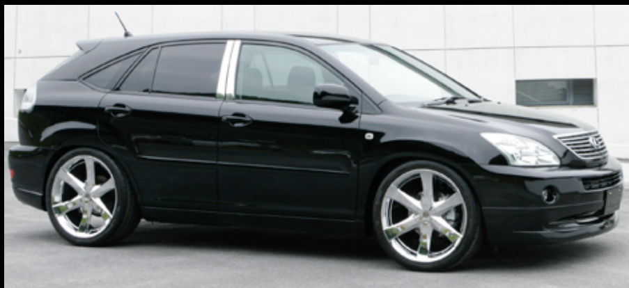
HARRIER HYBRID 22inch F.9.0J+32 R.9.0J+32 TIRE. F.255/30-22 R.255/30-22 ローダウンが必要です。
