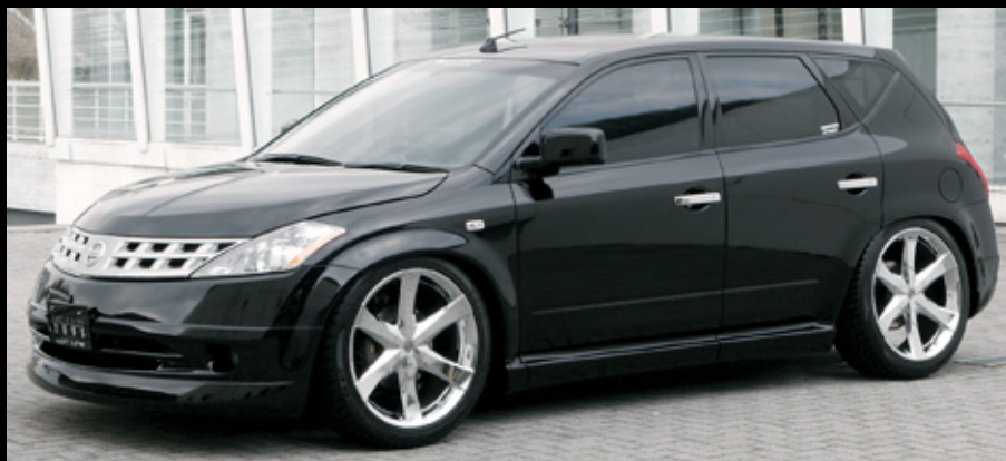
MURANO Z50 2WD 22inch F.9.0J+45 R.9.0J+45 TIRE. F.265/35-22 R.265/35-22 ローダウンが必要です。
