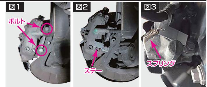
1. キャリパー固定ボルト(上下2本)を取り外し、付属のL型ステーを仮止めして下さい。
