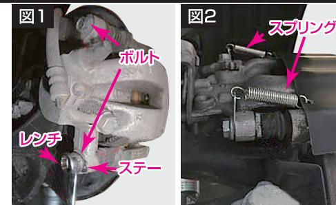
1. キャリパー固定ボルト(上下2本)を取り外し、付属のステーを仮止めして下さい。
