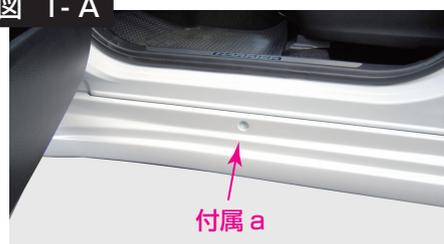
純正の取付け位置に付属 a を使用して固定して下さい。
