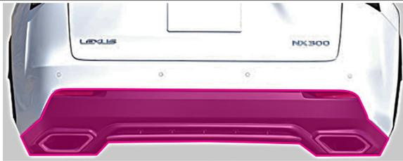
車両よりリアバンパーを取外し、上記   部のバンパーカバーロア、リフレクターの純正部品を取外して下さい。
