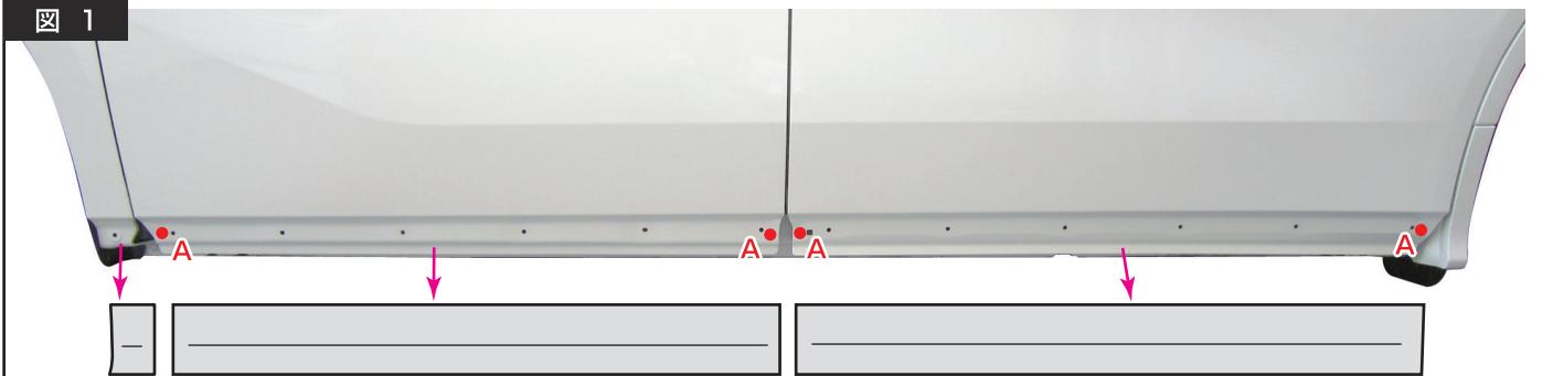
フロントフェンダー部、フロントドア部、スライドドア部に有る純正パネルを取り外して下さい。
