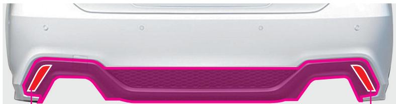
純正リフレクター 純正バンパーから、ディフューザー部を取外し車両へ戻して下さい。ディフューザー部より純正リフレクターを取外しスポイラーへ移設して下さい。
