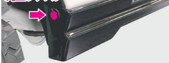
インナーライナーを固定している純正ファスナーを一度取り外し、スポイラーを車両へ取付後純正ファスナーで固定して下さい。
