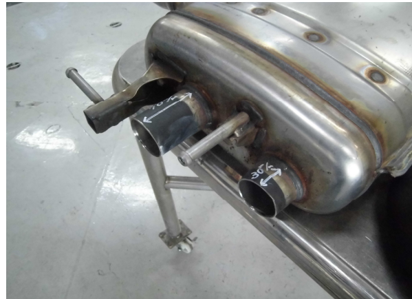
車体内側パイプカット位置 溶接部より30mm位置にて パイプカット
