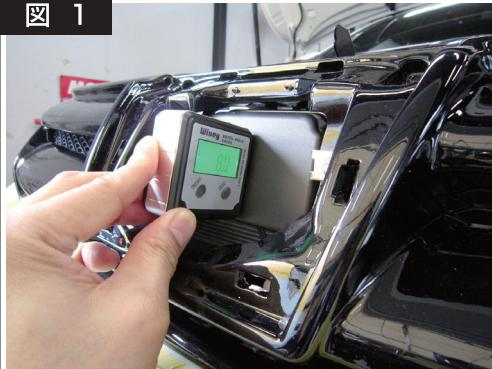
車両を水平な場所へ置き、ミリ波センサーの表面にデジタル角度計を当てミリ波センサーの取付角度を測定します。
