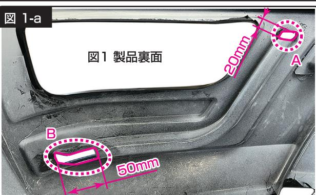
製品裏面のLED差し込み部を、**—**部の様に表面に影響の無い様に切り取って下さい。
