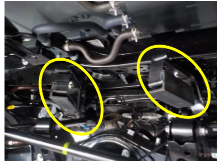
スペアタイヤオフセットスペーサー M8X15フランジボルト、ナットにて固
