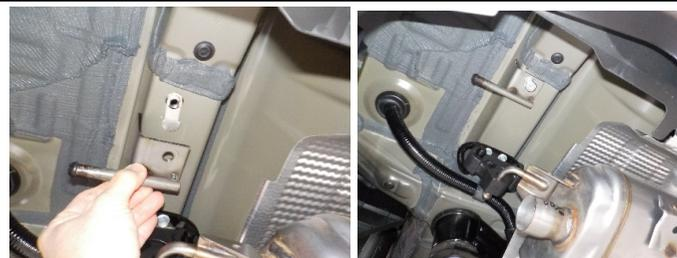
左右フレームの穴に、M10インプルナットを取付けしてください。
