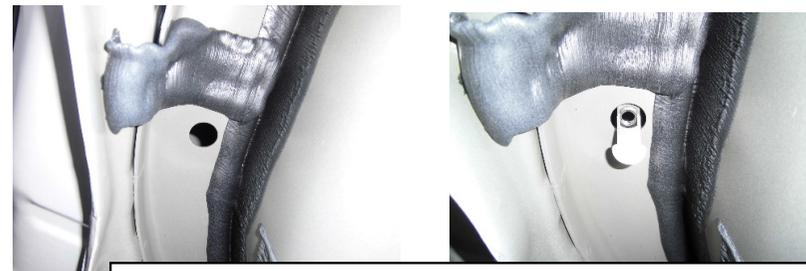
左側フレームの穴に、M10インプルナットを取付けしてください。
