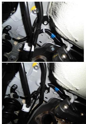
※キャニスター配管を、写真○位置のねじ位置を利用してブラケットと共に配管を移動してください。
