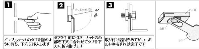
インプルナットのタブを図のように持ち、下穴に挿入します
