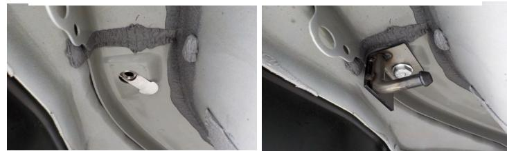
左側フレームの穴に、M10インプルナットを取付けしてください。
