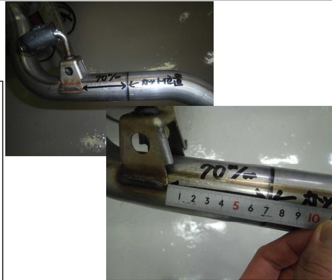
純正吊下げブラケットベースパイプ溶接部の後端より70mm位置にて純正マフラーを切断。
